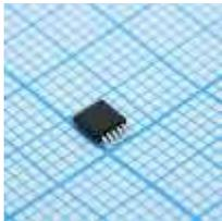
Линейный стабилизатор с низким падением напряжения положительной полярности 0.4В до 2.6В 1.5А
