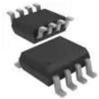
Регулируемый стабилизатор с низким падением напряжения положительной полярности, 0.5 A
