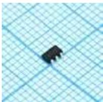
Линейный стабилизатор с низким падением напряжения положительной полярности, 3 В, 0.3 А
